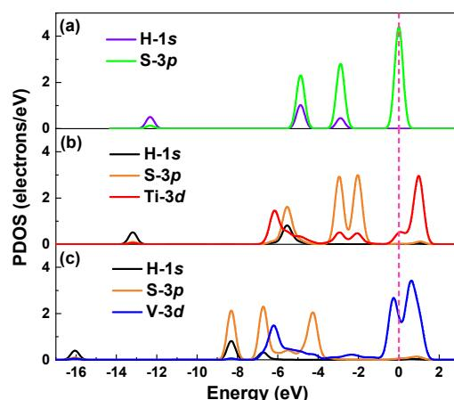
图 7 H<sub>2</sub>S 分子在 Ti/Ti<sub>2</sub>CO<sub>2</sub> (b) 和 V/Ti<sub>2</sub>CO<sub>2</sub> (c) 表面吸附前(a)后(b, c)的 S、H 以及单原子的 PDOS 图
