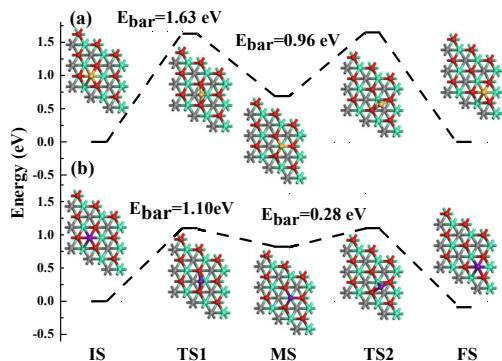
图2 Ti (a)和 V (b)原子在  $\text{Ti}_2\text{CO}_2$  表面上的扩散路径图
