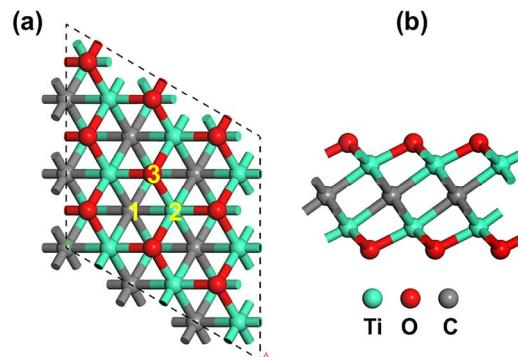
图 1 单层  $\text{Ti}_2\text{CO}_2$  的俯视(a)和侧视图(b)
