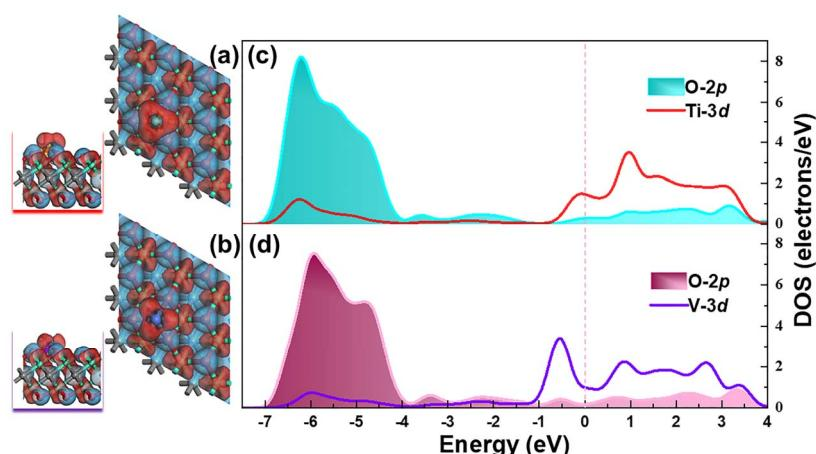
图3 单原子 Ti (a)和 V (b)负载在单层  $\text{Ti}_2\text{CO}_2$  表面上差分电荷密度的俯视和侧视图,其中等电荷密度值为 $\pm 0.032$  a.u..青色和红色分别代表电荷的聚集和丢失区域。(c) Ti/Ti<sub>2</sub>CO<sub>2</sub> 和(d) V/Ti<sub>2</sub>CO<sub>2</sub> 的分波态密度,虚线代表费米能
