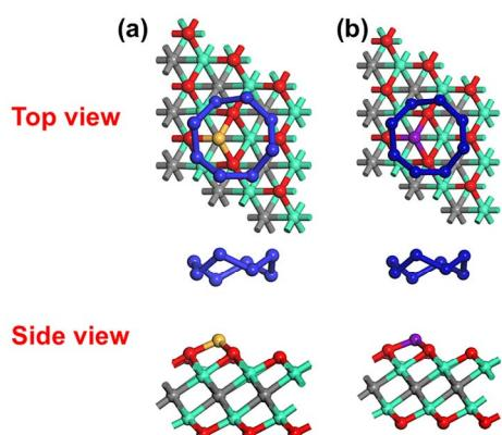
图 6 S<sub>8</sub>在 Ti/Ti<sub>2</sub>CO<sub>2</sub> (a) 和 V/Ti<sub>2</sub>CO<sub>2</sub> (b) 表面吸附的主视和侧视图
